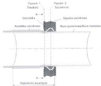
Rys. 3. Połączenie w systemach Mapress o profilu cytryny.
