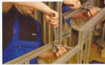
10, 11. Mrozoodporny zacisk umożliwia bardzo wygodny i szybki montaż stelaża, ale wymaga otwiera nieco większą siłę. Z tego względu warto poszukać się odpowiednim narzędziem np. regulowanym kluczem.
